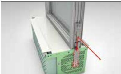
Abb. 9: Befestigungsstiel in den vormontierten Montageschuh einschieben.
