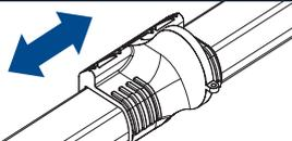
Nach rechts bzw. links schieben um Stahlseil zu spannen bzw. entspannen
