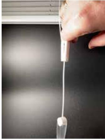
Ihr Plisseo ist mit einer der Europäischen Norm DIN EN 13120 entsprechenden Kindersicherung ausgestattet. Kommt ein Kopf/Körperteil etc. zwischen die freihängenden Schnüre, teilt sich der Schnurverbinder unter der von oben ausgeübten Kraft in zwei Teile und gibt die Schnüre frei. Eine bzw. zwei der Schnüre sind frei, die zwei anderen sind mit den 2 Hälften der nun geteilten Kindersicherung verbunden.
